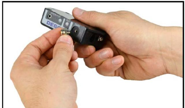
Рисунок 9. Замена разъема «паркинг» на тестере непрерывного мониторинга.
