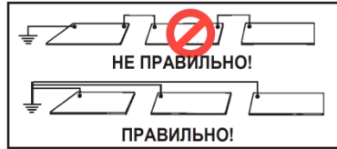
Рисунок 2. Антистатические рабочие поверхности никогда не следует заземлять последовательным подключением.
