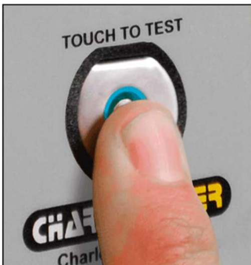
Рисунок 10. Замыкание контактов кнопки включения режима тестирования
