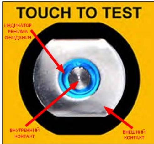
Рисунок 9. Внешний вид и составные части кнопки включения режима тестирования.
