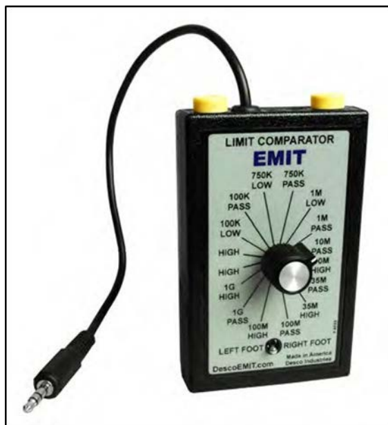
Рисунок 11. EMIT 50424 калибратор комбинированного тестер-стенда Combo Tester X3.
