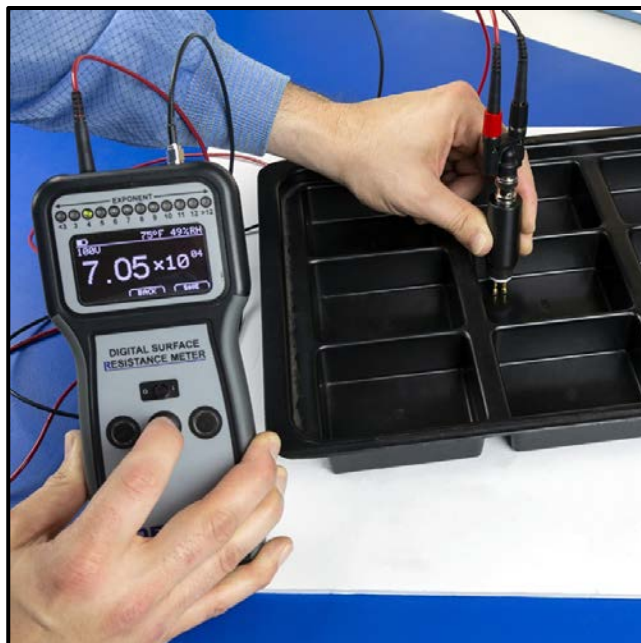
Рисунок 2. Применение двухточечного датчика сопротивления DESCO 19297 с измерителем поверхностного сопротивления DESCO 19290.
